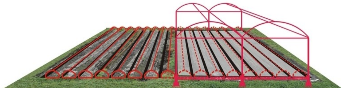
Rys.1. Suszarnia słoneczna na czterech poletkach osadowych o łącznej pow. 528 m 2 w tym dwóch poletkach osadowych – 264 m 2 przykryte folią bądź poliwęglanem.
